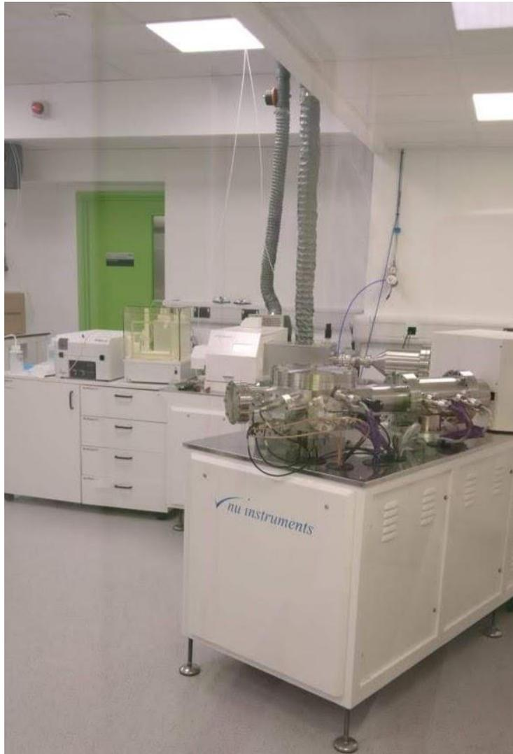
Figura 1. Espectrômetro de massa multicoletor (MC-ICP-MS) modelo Nu-Plasma2 do laboratório CELTIC
